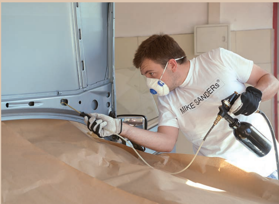
Przed zabezpieczeniem zasłonięto maskę i komorę silnika.
